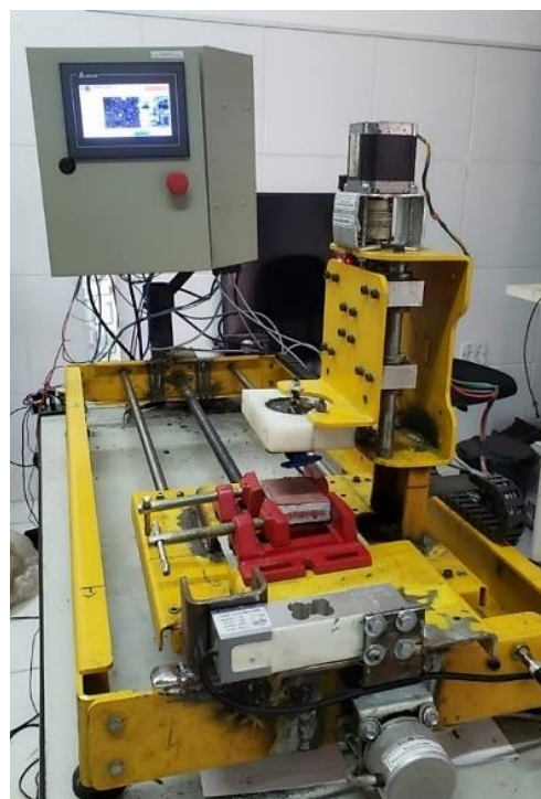
Figura 4 – Equipamento dedicado desenvolvido para a determinação do alongamento e da força de ruptura dos corpos de prova. Fonte: autores, 2022.
